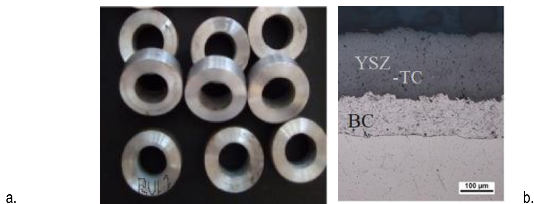
Fig. 1. a. Esantioane; b. Realizarea stratului de TBC
